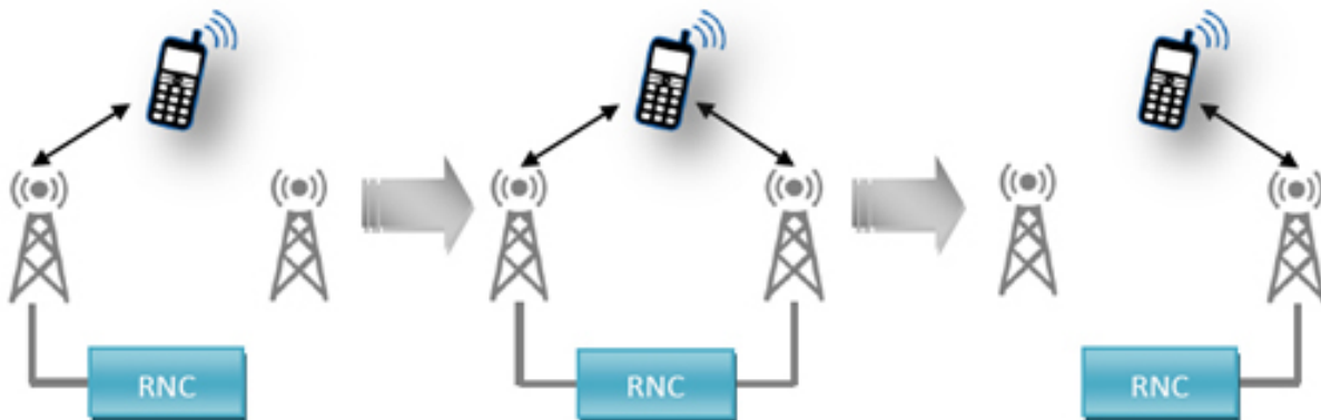
Figure 10. Etapes du Soft handover an niveau d'un seul RNC
